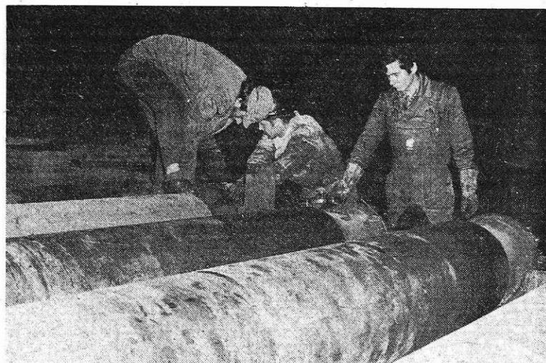
Sodelavci – vzdrževalci pri remontu v valjarni bluming štekel (Foto S. Kokalj)
