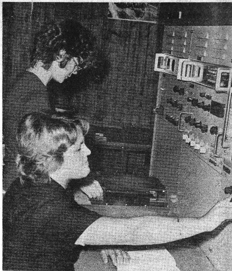
Magnetna kontrola hladno valjanih trakov v hladni valjarni Bela (Foto S. Kokalj)
