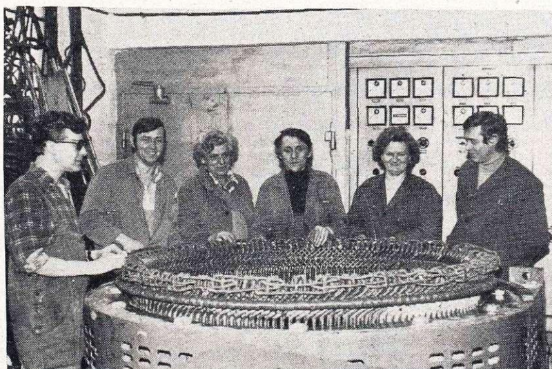
Sodelavci DES po uspešno opravljenem celotnem previtju 450 HP Westinghous elektro motorja zračnega kompresorja energetske postaje Bela.
