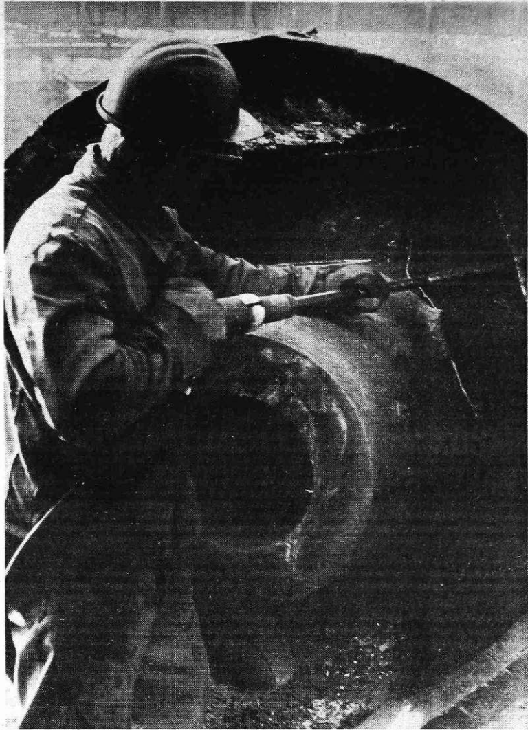
Sodelavec pri čiščenju odlitka v livarni
