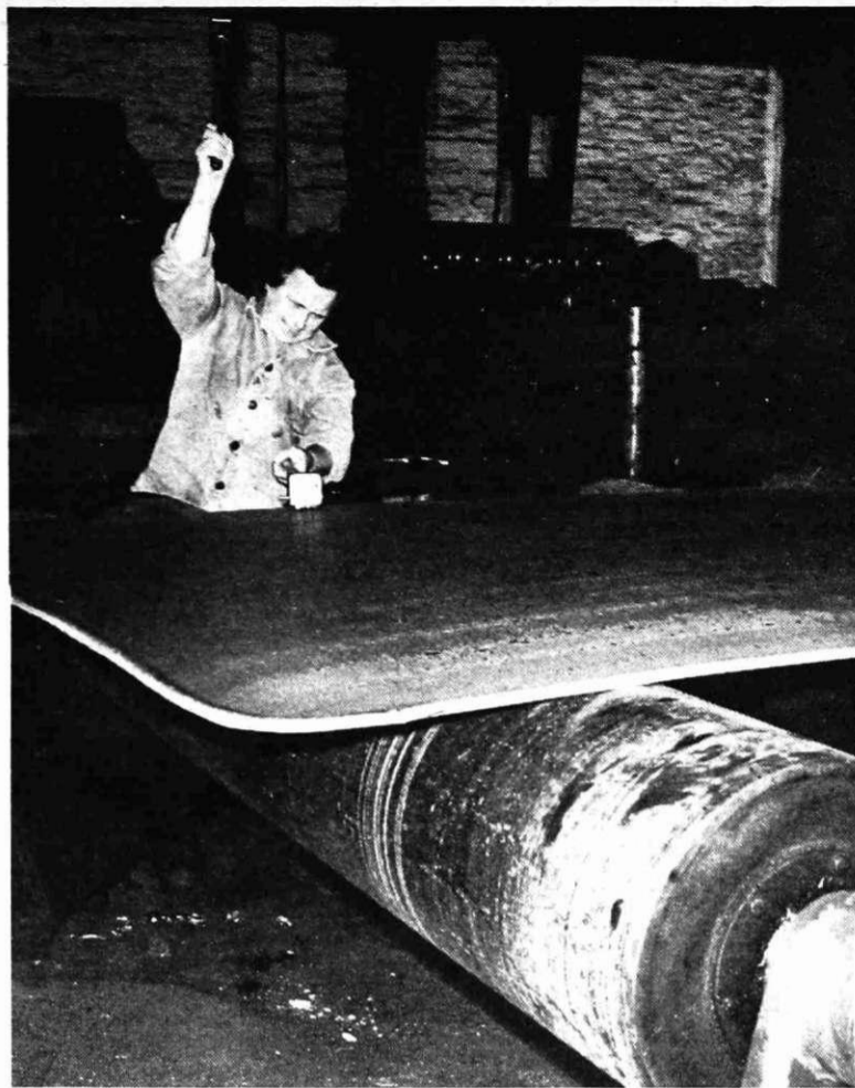
Sodelavka pri žigovanju debele pločevine
