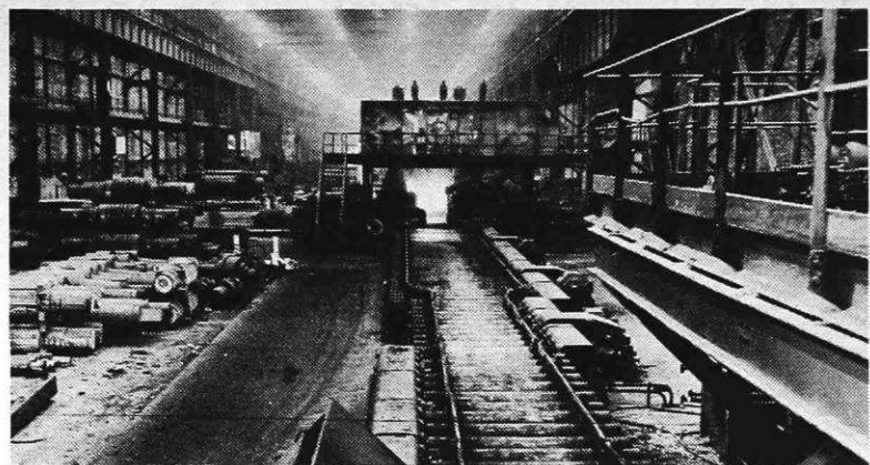
Del potisne peči, v ozdaju valjarna bluming
