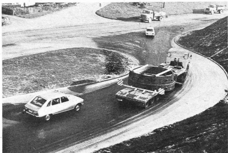
Odprema odlitka »prstena« za cementarno Usje, ki je bil izdelan v naši livarni
