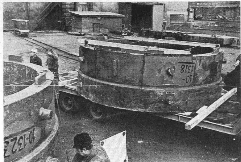
»Prsten« za cementarno Usje so odšli naši sodelavci v livarno. Premer »prstena« je okrog štiri metre, en kos pa tehta bruto 28 ton. Odlitek dokončno obdelajo v ljubljanskem Litostroju, kjer imajo za to ustrezne stroje.
