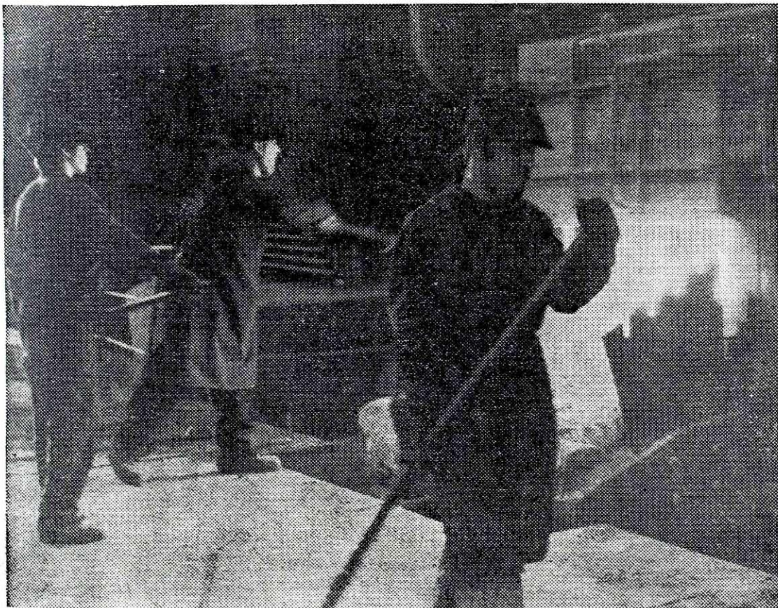
Uglašen trio naših talilcev — dodajanje primesi v ASEA električno peč
