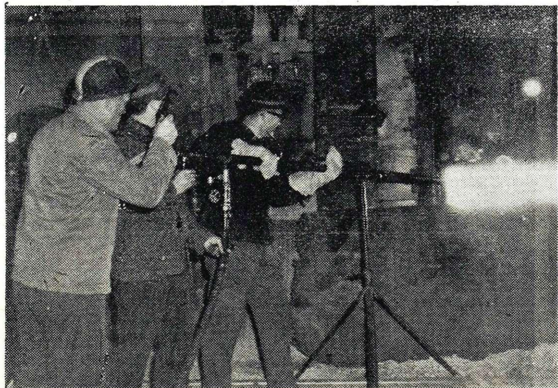
Preizkušanje gorilca za mazut, ki ga bodo uporabljali za dodatno taljenje vložka v naši sedemtonski elektro peči
