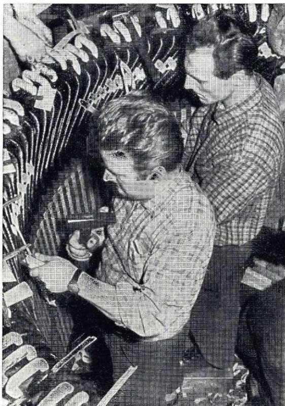
Delo pri previjanju Leonardovega motorja za težko progo na Javorniku Foto: Kolman
