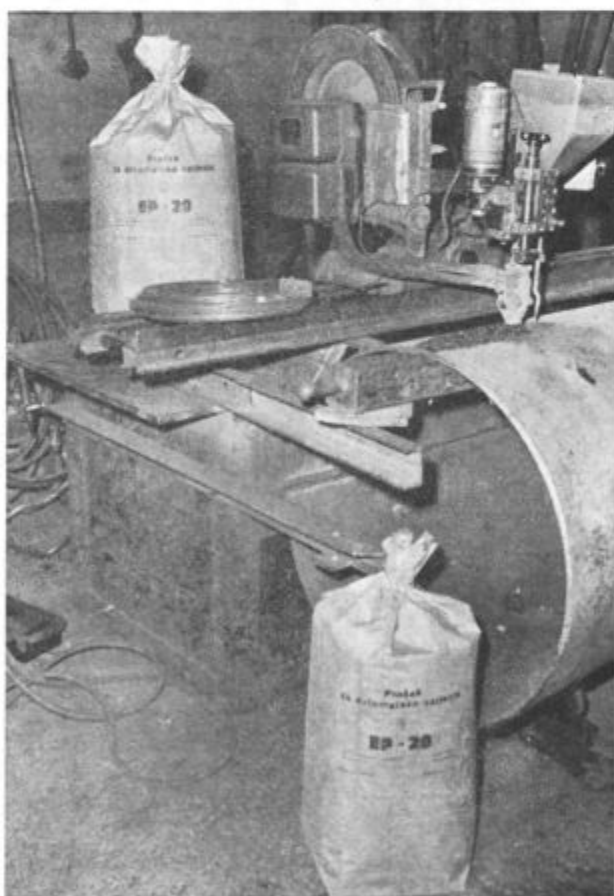
Slika 2 LINDEJEV aparat med varjenjem cevi
