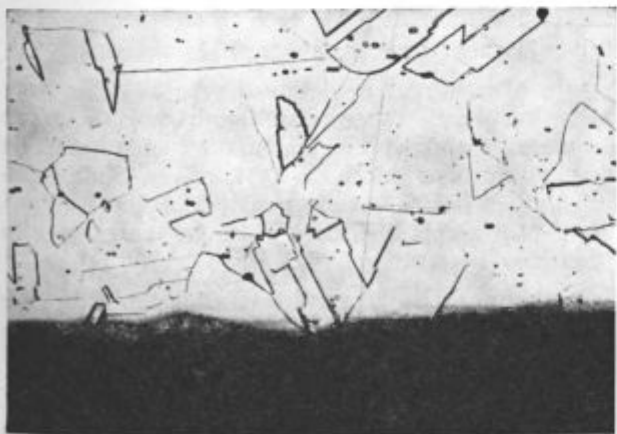
Slika 25 — 100\times Jedkano z V 2A jedkalom. Gašeno 1100^\circ\text{C} — voda
