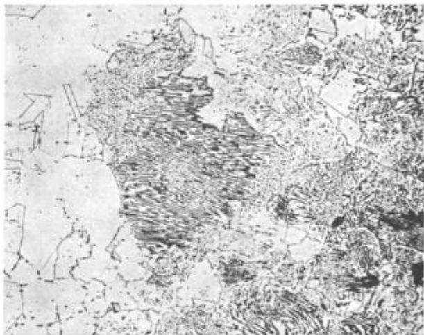
a) po cementiranju in homogenizaciji 1180° C/1 h
