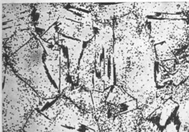
Slika 30 — 500× Elektrolitsko jedkano v 15 % Cr kislini. Talina s 5 % Mn. Gašeno 1100° C — voda in žarjeno 750°/250h
