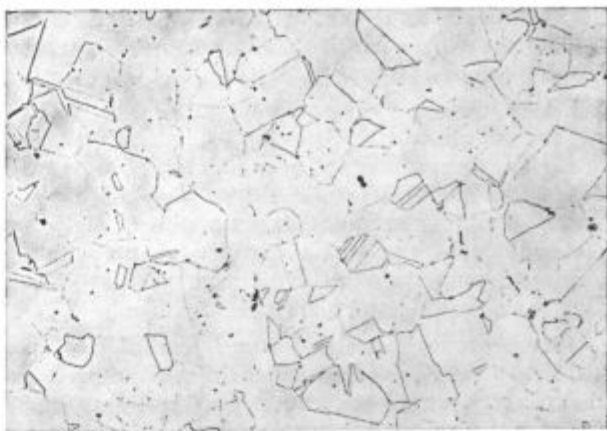
Slika 12 — 100× Jedkano z V 2A jedkalom. Gašeno 1100° C — voda
