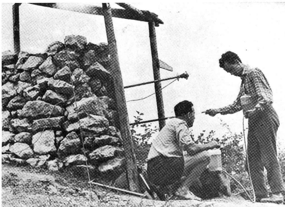
Slika 70 — Jemanje pečnih plinov s pomočjo nivojnih steklenic
