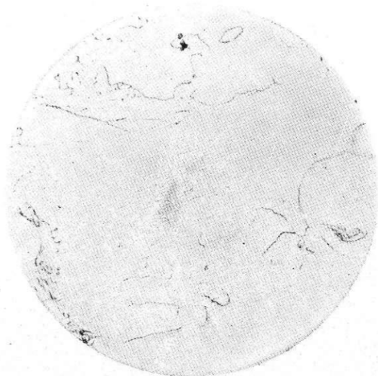
Slika 24 — Mikrostruktura hlebčastega železa »volka« — 100 x
