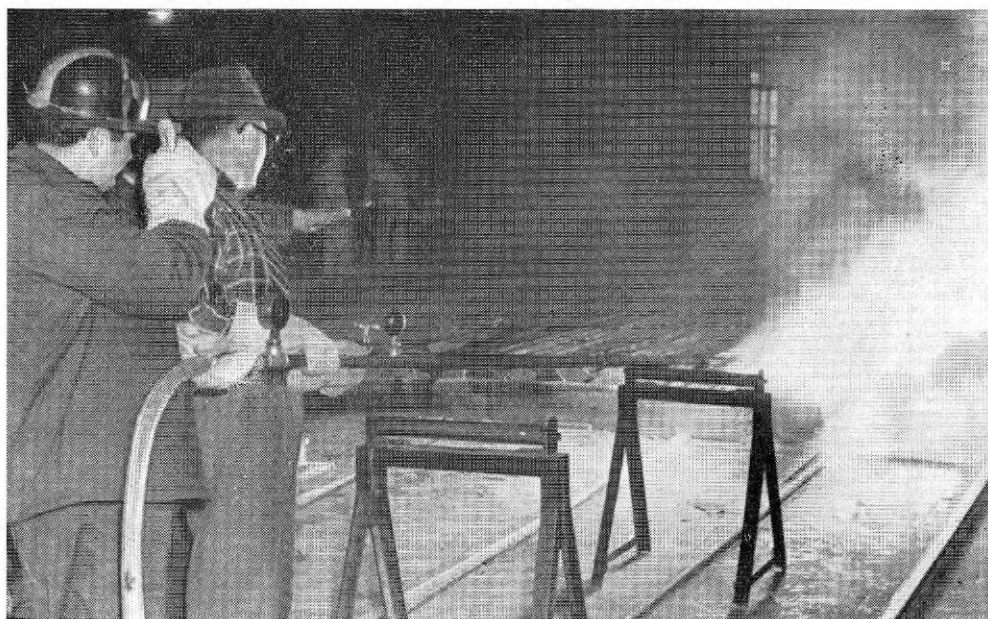
Slika 4 — Delovanje gorilca zunaj peči
