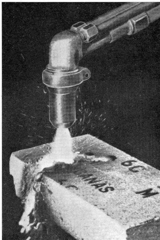
Slika 8 — Rezanje opeke s praškom
