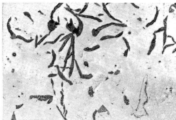
Slika 23. Grafitna zrna so debelejša, velikost 4 po ASTM (x 100)
