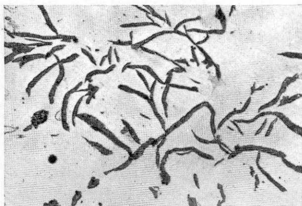
Slika 24. Delež izločenega grafita je mnogo večji, velikost 3–4 po ASTM (x 100)
