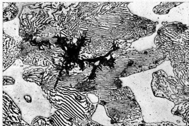
Slika 33. Struktura perlit + ledeburit + s prvo grafitno celico (x 500).
