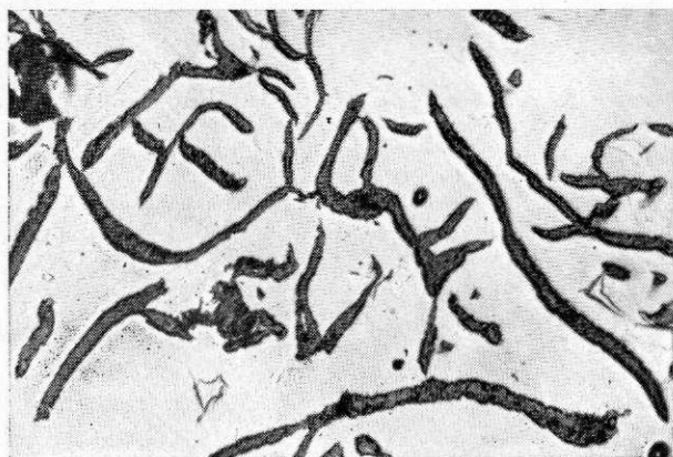
Slika 25. Vzorec, vzet iz jedra, velikost grafitnega zrna 3 po ASTM (x 100)
