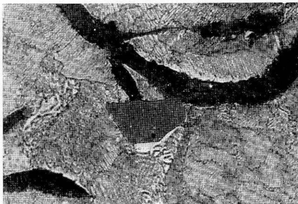
Slika 31. Struktura perlit + grafit s sulfidnim vključkom (x 500).
