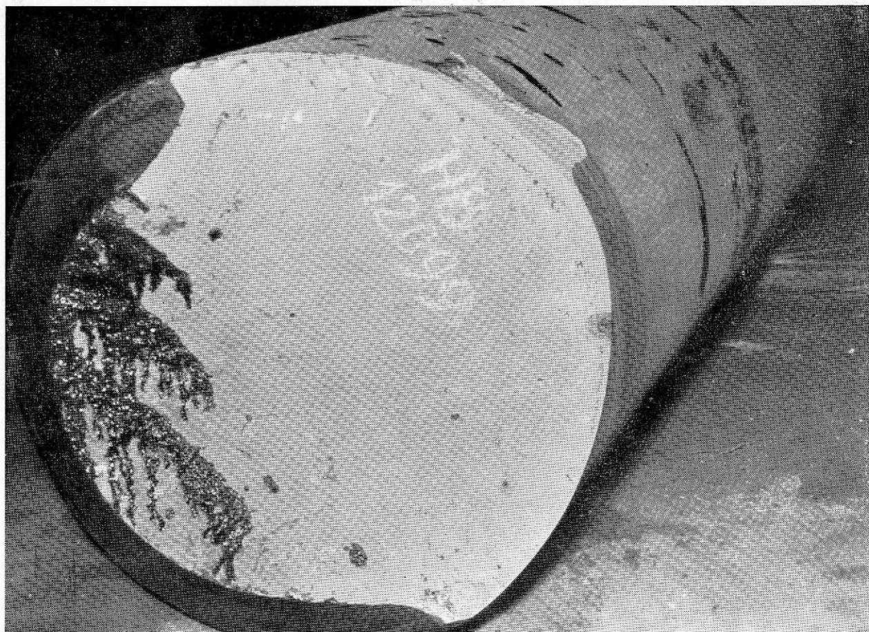
Slika 12 in 13 – Zlom valja na prehodu od delovne površine na čep
