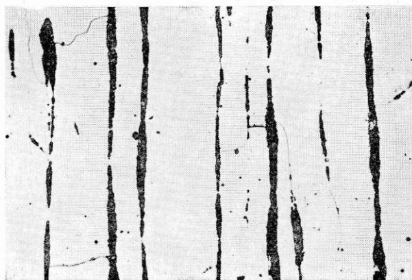
Slika 12 — Struktura ferita in perlitna pri normalni kristalizaciji jekla (x200)
