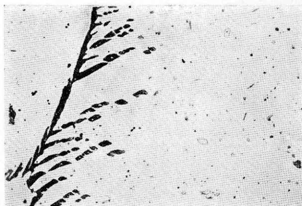
Slika 4 — Lamelarni perlit s poligonalnimi karbidi (x 100)
