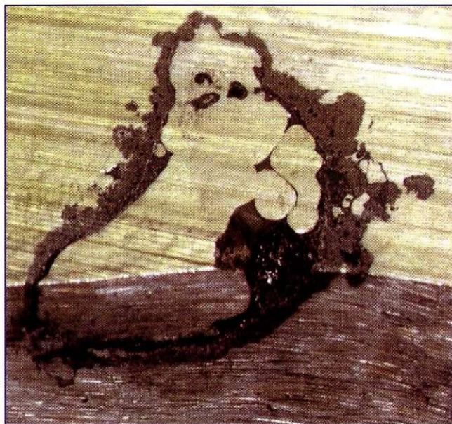
Kovinski strdek v ostanku livnega praška v slabu.
