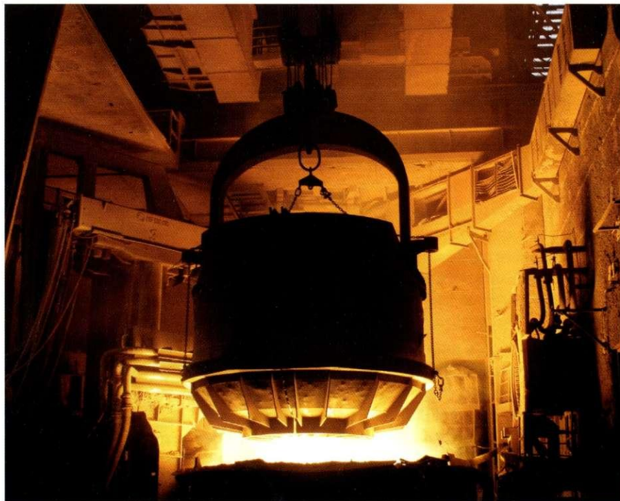
Zakladanje jeklenega vložka z vrha peči
