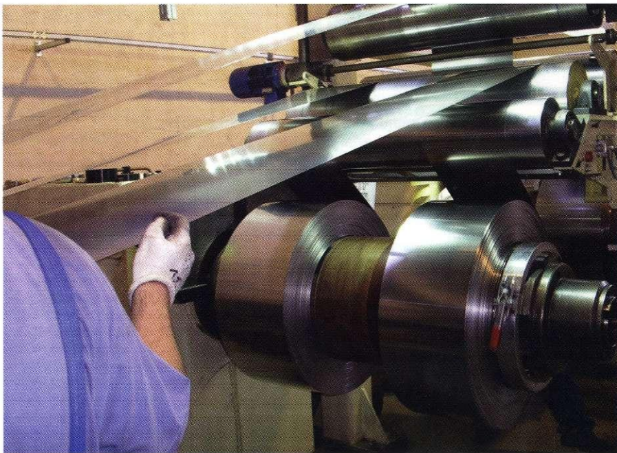
Razrez kolobarja pri kupcu MK – Metallfolien v V Nemčiji
