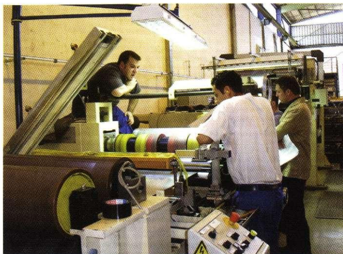
Vizualna kontrola površine traku pri našem kupcu MK – Metallfolien in Nemčiji
