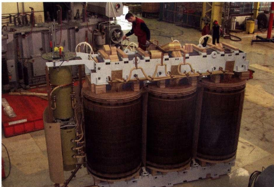
Takšen je aktivni del transformatorja.
