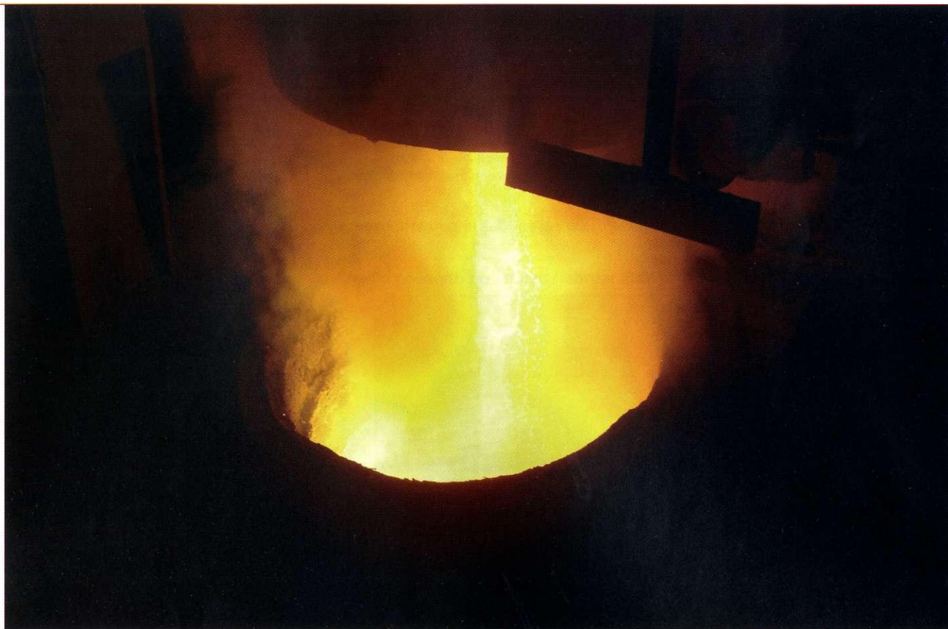
Prebod prve 110 t šarže nerjavnega jekla iz EBT peči. Sledi postopek VOD obdelave.
