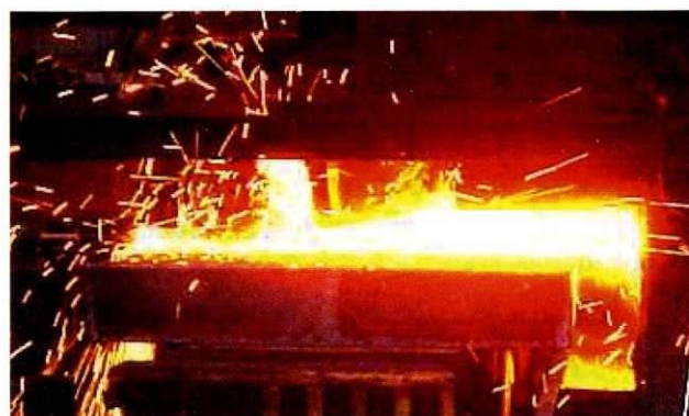
Brušenje površine prevajanega slaba
