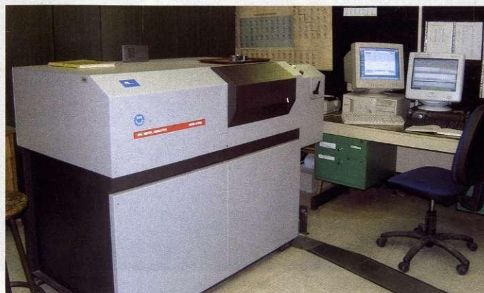
Spektrometer z računalnikom za vodenje procesov - s povezavo računalnika za unos podatkov v sistem KALI v mrežo Acronija, bo prenos podatkov s spektrometra lahko potekal avtomatsko.
