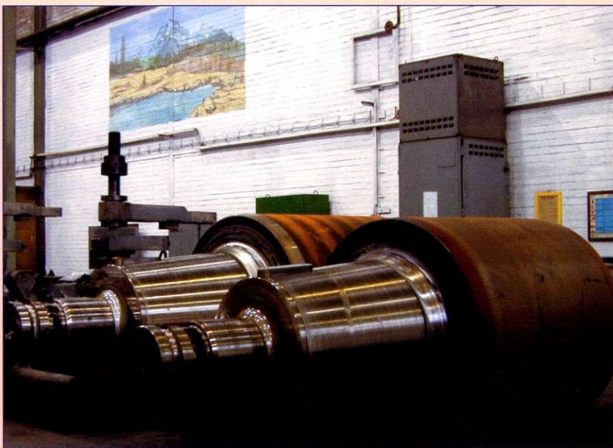
Valji v brusilnici valjev čakajo na obdelavo.
