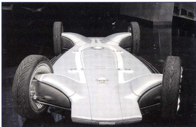
Izgled šasije, v kateri so vgrajeni vsi pomembni pogonski in krmilni deli.
