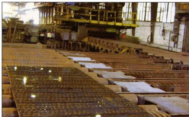
Plošča po kaljenju, s katero ravnalni stroj MDS v ozadju ne bo imel veliko dela.
