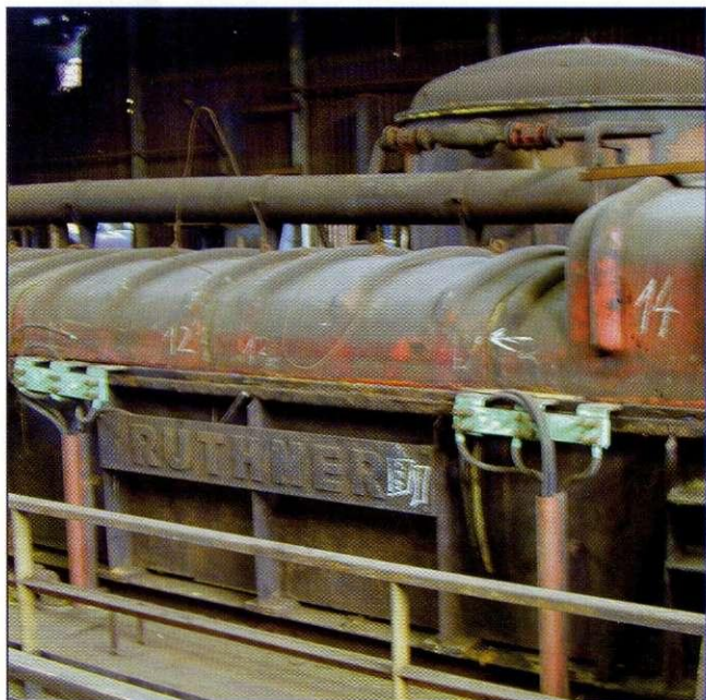
Elektrolitsko luženje poteka v zaprtih kadeh na Ruthnerjevi napravi.
