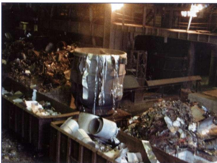
Polnjenje košar z jeklenim odpadkom v Jeklarni
