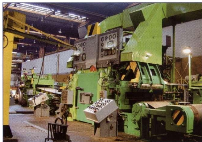
Vse naprave so v letošnjem letu prebarvali - na fotografiji je valjalni stroj SENDZIMIR.
