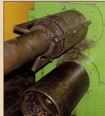
Varovanje pogonske gredi delovnih valjev proti izpadanju CTM je ena od sedmih Džurovih inovacij v letošnjem letu.
