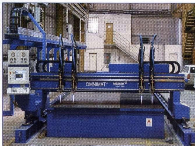
Podobna obnovljena naprava (manjša) s samo avtogenimi gorilniki.
