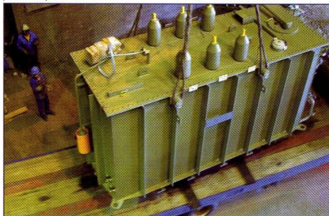
Prve dni junija je firma SGB iz nemčije dobavila 40 t težko dušilko in 80 t težak nadomestni transformator za elektroobložno peč. Dušilka bo dograjena v prizidek na EOP predvidoma v avgustu, transformator pa v eni od prihodnjih daljših ustavitve. Na sliki zgoraj: tovor čaka na carinjenje, spodaj dviganje dušilke na podest ob peči.
