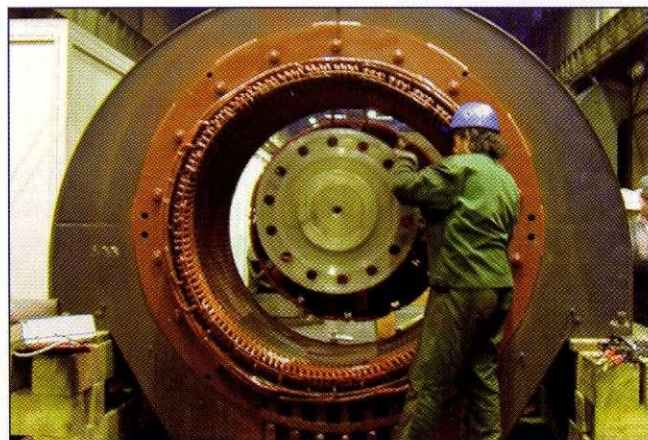
In potem namestiti rotor v stator z žerjavom. Delo je zelo natančno in zahtevno.
