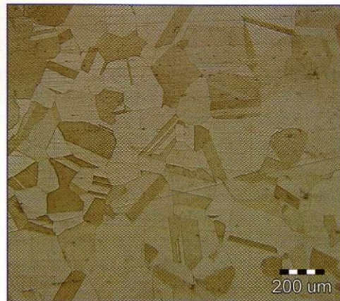
Mikrostruktura nikljeve zlitine Gammaphy, gašeno stanje.
