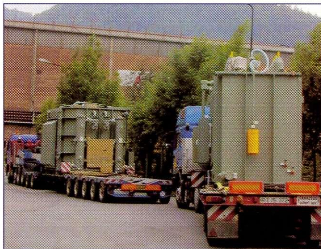
Prve dni junija je firma SGB iz nemčije dobavila 40 t težko dušilko in 80 t težak nadomestni transformator za elektroobložno peč. Dušilka bo dograjena v prizidek na EOP predvidoma v avgustu, transformator pa v eni od prihodnjih daljših ustavitve. Na sliki zgoraj: tovor čaka na carinjenje, spodaj dviganje dušilke na podest ob peči.
