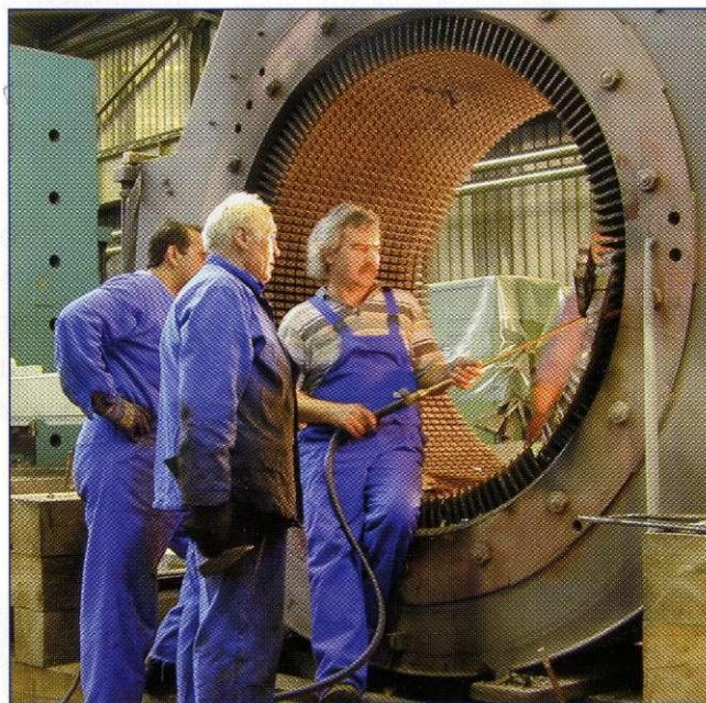
15. maj - odstranjevanje tuljav iz statorja gre proti koncu.
