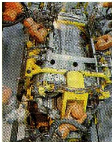
Robotizirano lepljenje in točkovno varjenje stranskih okvirov med izdelavo BMW serije 7. V avtomobilu je kar 140 m lepljenih in kombiniranih lepljenih/točkovno varjenih spojev.
