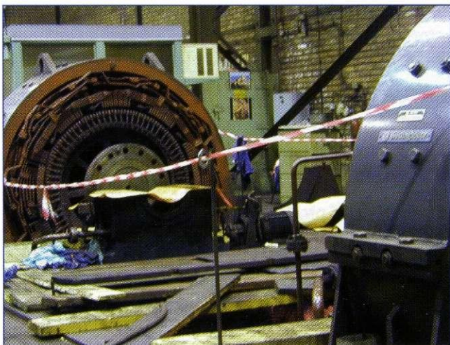
Pogonski motor je bil prepeljan v delavnico Pilastra, kjer bodo skupaj s podjetjem Elektroremont Izola zamenjali navitja v statorju ter očistili in prelakirali rotor.
