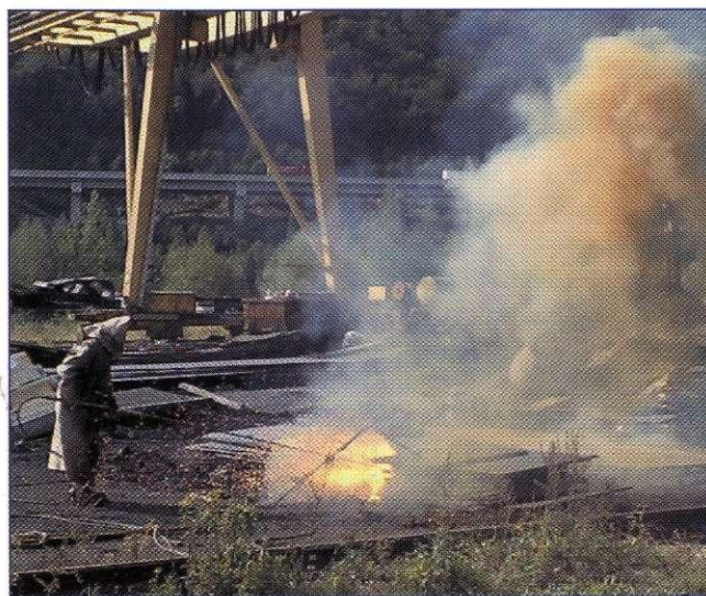
Plamenski rezalec na nasipu.
