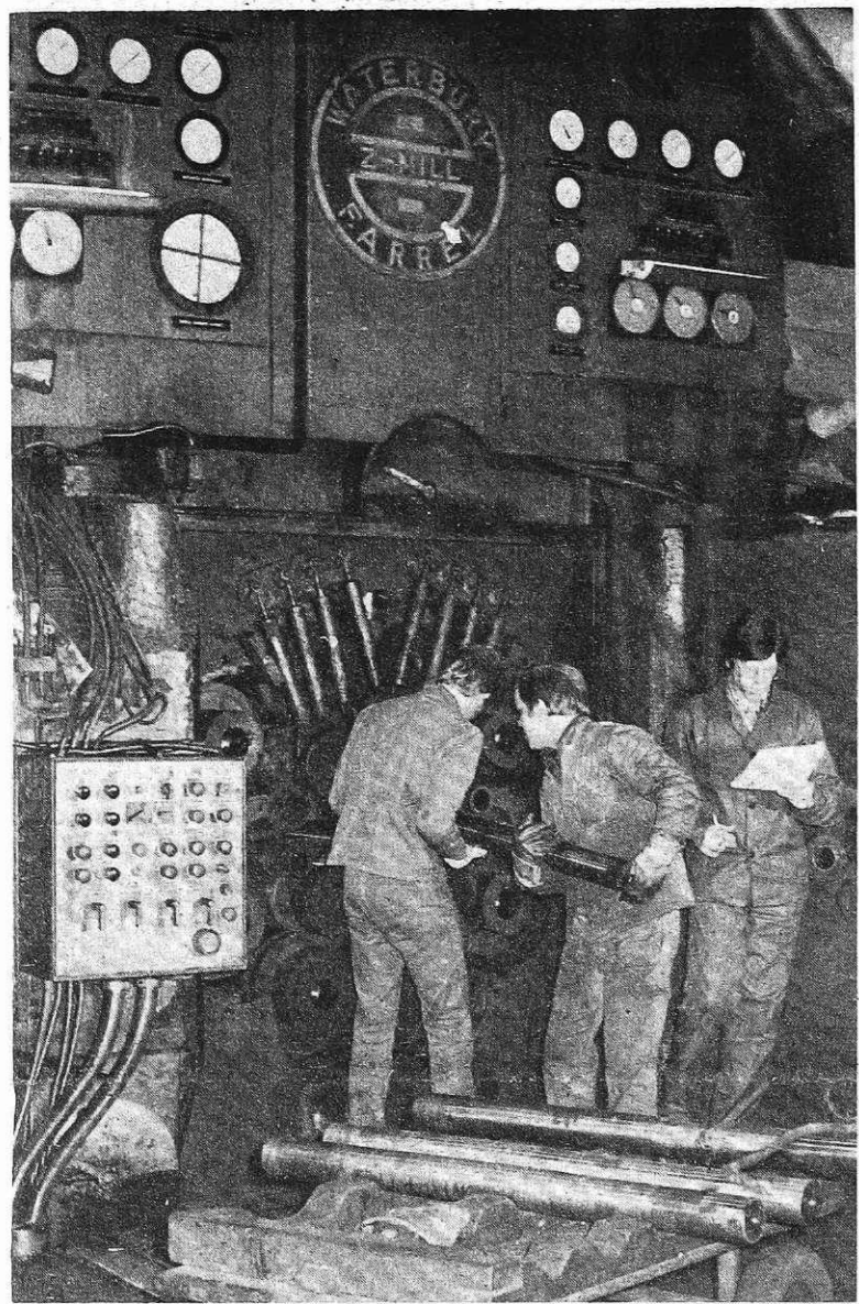
Božo Miloš, Pero Stanič in Semir Hadžić pri menjavi valjev na Sendžimir ogrođu (foto I. Kučina)
