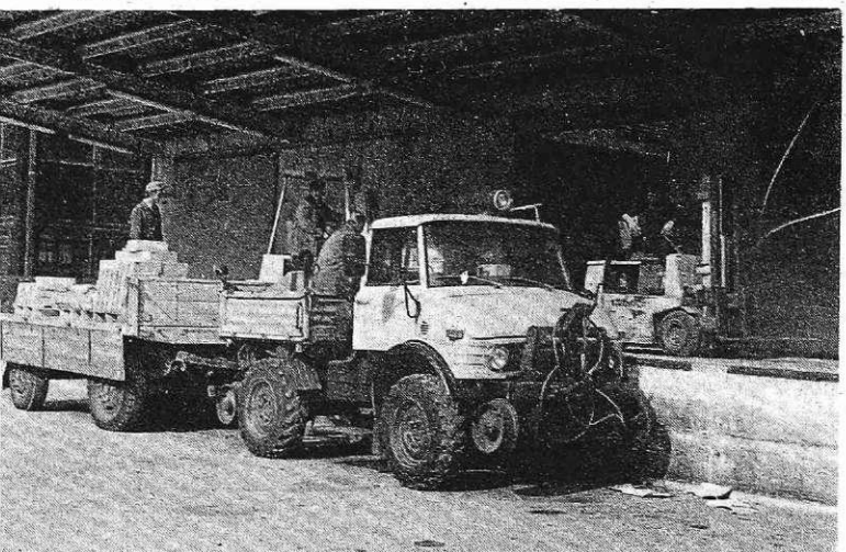
Pri Universalu na Plavžu imajo mali tovornjak FIRME UNIMOG, ki je »dvočevka«. Normalno lahko vozi po cesti, na železniških tirih pa spusti železniška kolesa, tako da lahko vozi tudi po tračnicah. Kadar vozi po železniškem tiru ga uporabljajo za premik železniških vagonov na njihovem industrijskem tiru. Tudi pri vožnji po tiru se tovornjak poganja z gumijastimi kolesi, jeklena kolesa s kolesnim vencem pa služijo kot vodilo za vožnjo po tračnicah. (tekst in foto: B. Blenkuš)
