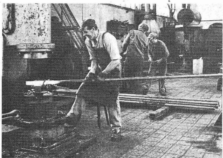
Kovanje zamašnega droga za martinarno (foto I. Kučina)
