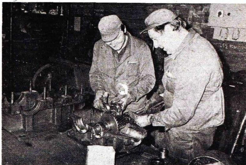
Sestavljanje reduktorja za žerjav v delavnici vzdrževanja na Beli (foto S. Kokalj)
