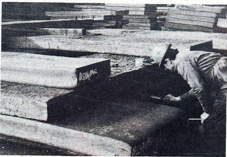
Signiranje slabov v valjarni Bela (foto I. Kučina)
