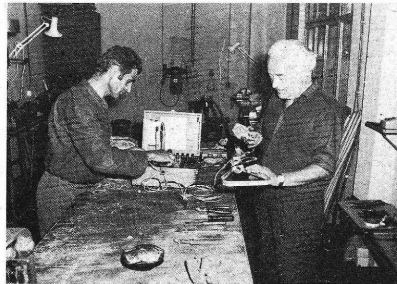
Popravilo merilnega kopja za martinarno v delavnici RTA (foto S. Kokalj)
