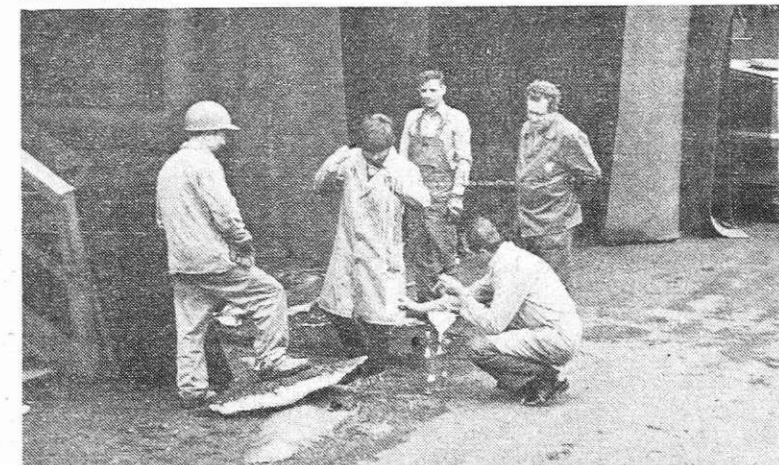
Kontrola odplak v odtočnih kanalih pri plavžih (Foto I. Kučina)
