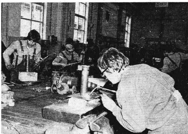
Plamensko varjenje – delovno tekmovanje kovinarjev v instalacijski delavnici (Foto S. Kokalj)
