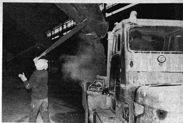
Rudarna — priprava vložka za SM peč (Foto I. Kučina)
