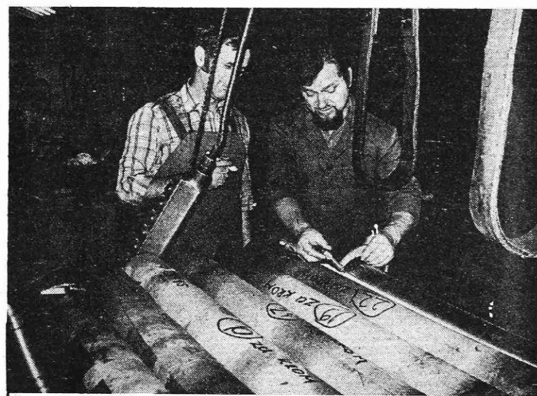
Priprava valjčnic za Sendzimir v HVB (Foto I. Kučina)
