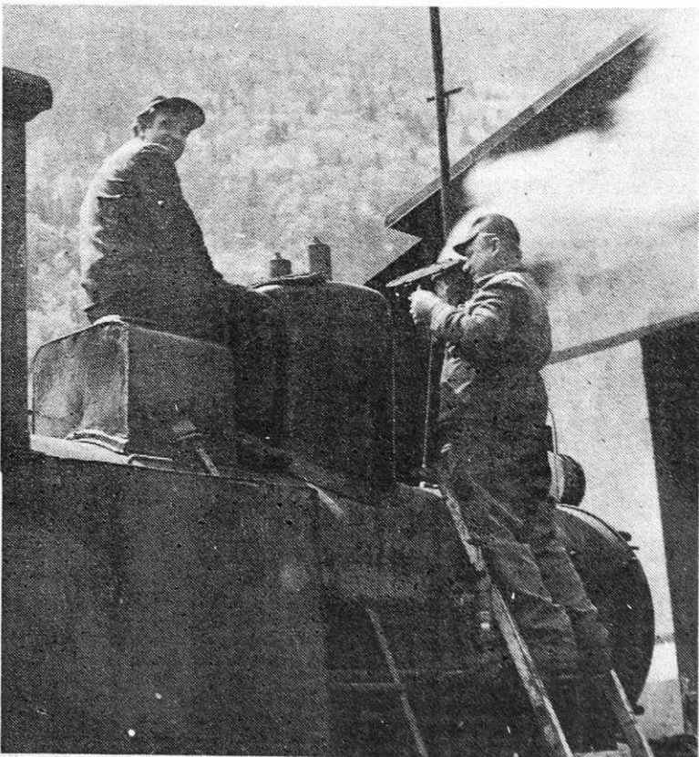
Sodelavca pri pregledu varnostnih ventilov na lokomotivi (IK)
