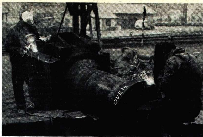
Iz specialne kvalitete izdelan OVEN za veliko stiskalnico v TAM Maribor
