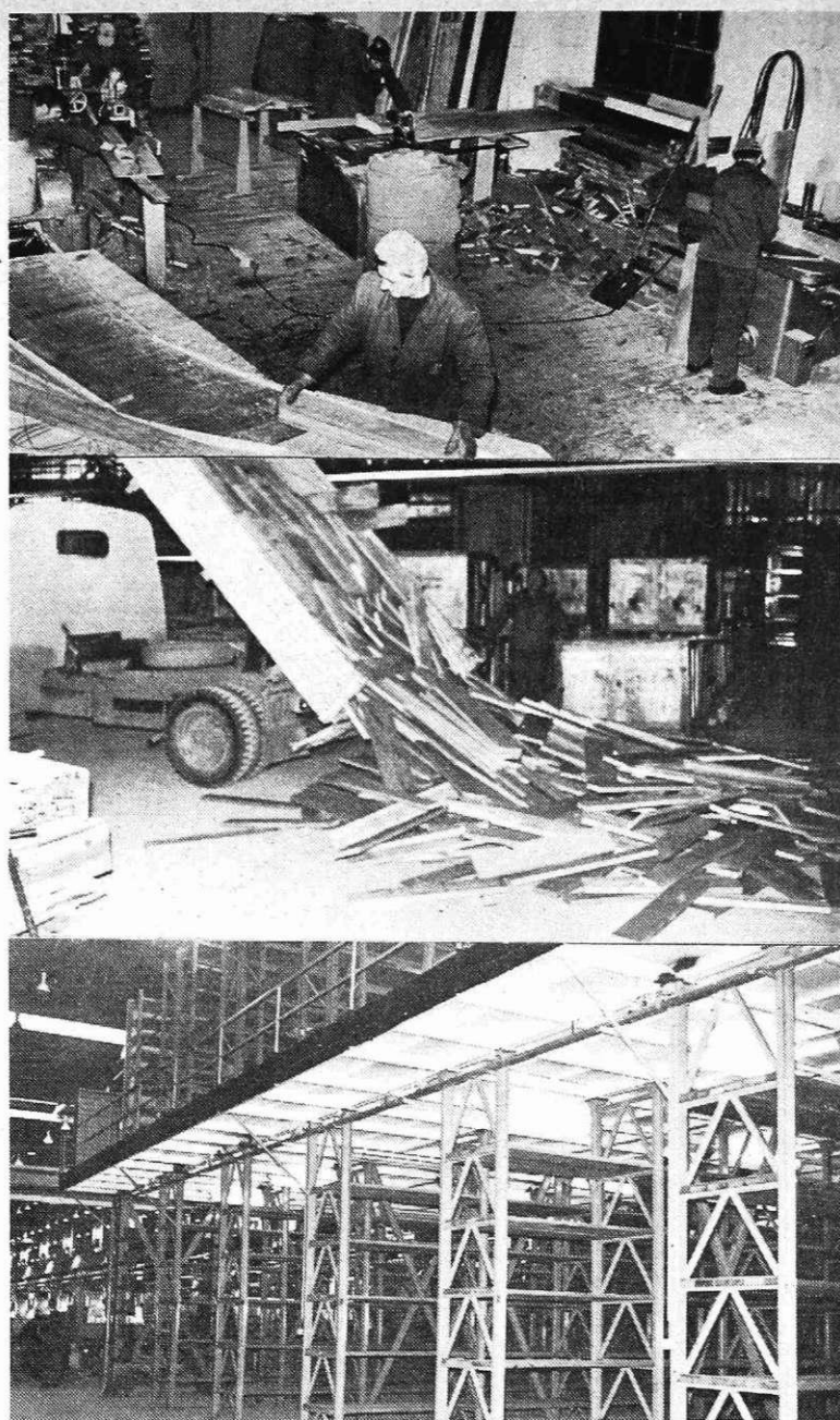
Delavci mizarne GV obdelujejo police za skladišče hladne valjarne Bela. Obdelovanje polic so si pripravili po sistemu tekočega traku, da je čim manj zastojev. Druga skupina pa je sestavljena iz vseh delavnic GV in izdelane police sproti montira v novem skladišču hladne valjarne; — dela morajo biti zaključena v najkrajšem času — prosti starega skladišča nujno potrebujejo za razširitev delavnic vzdrževanja
