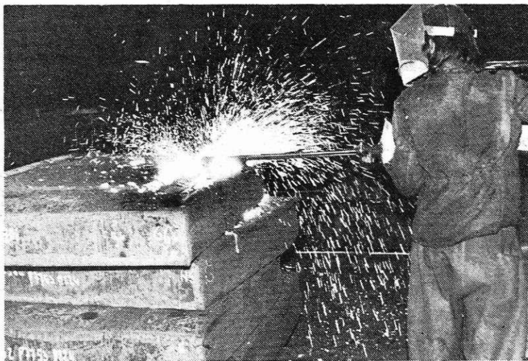
Sodelavec pri čiščenju površinskih napak v adjustaži valjarne bluming
