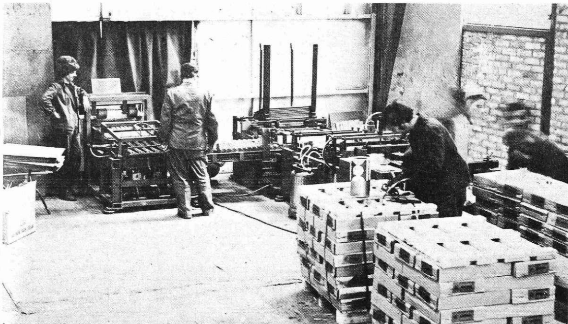
Pakiranje elektrod na novem avtomatskem stroju.
