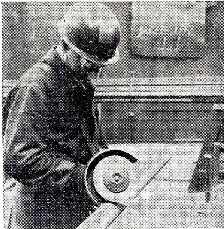
Brušenje površinskih napak na profilih v valjarni profilov
