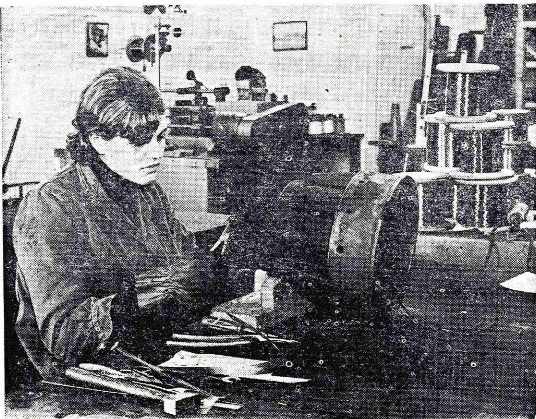
Sodelavka pri previjanju elektromotorja
