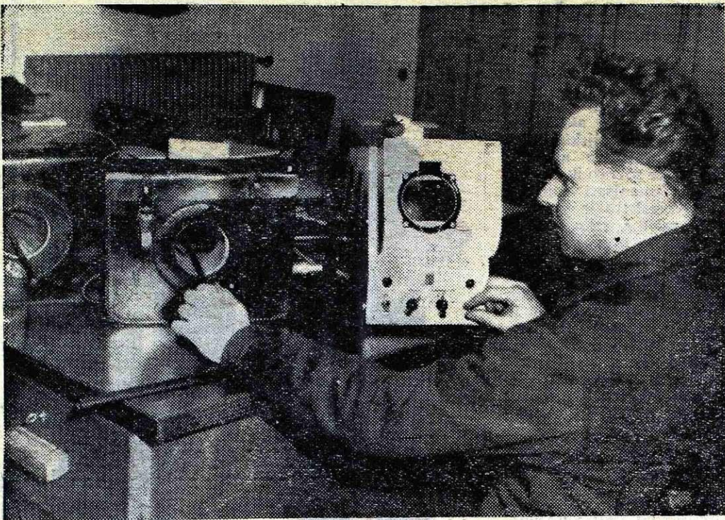
Kar ne zmorejo človeška čutila, nadomesti aparatura. Na sliki primerjava materiala s komparatorjem
