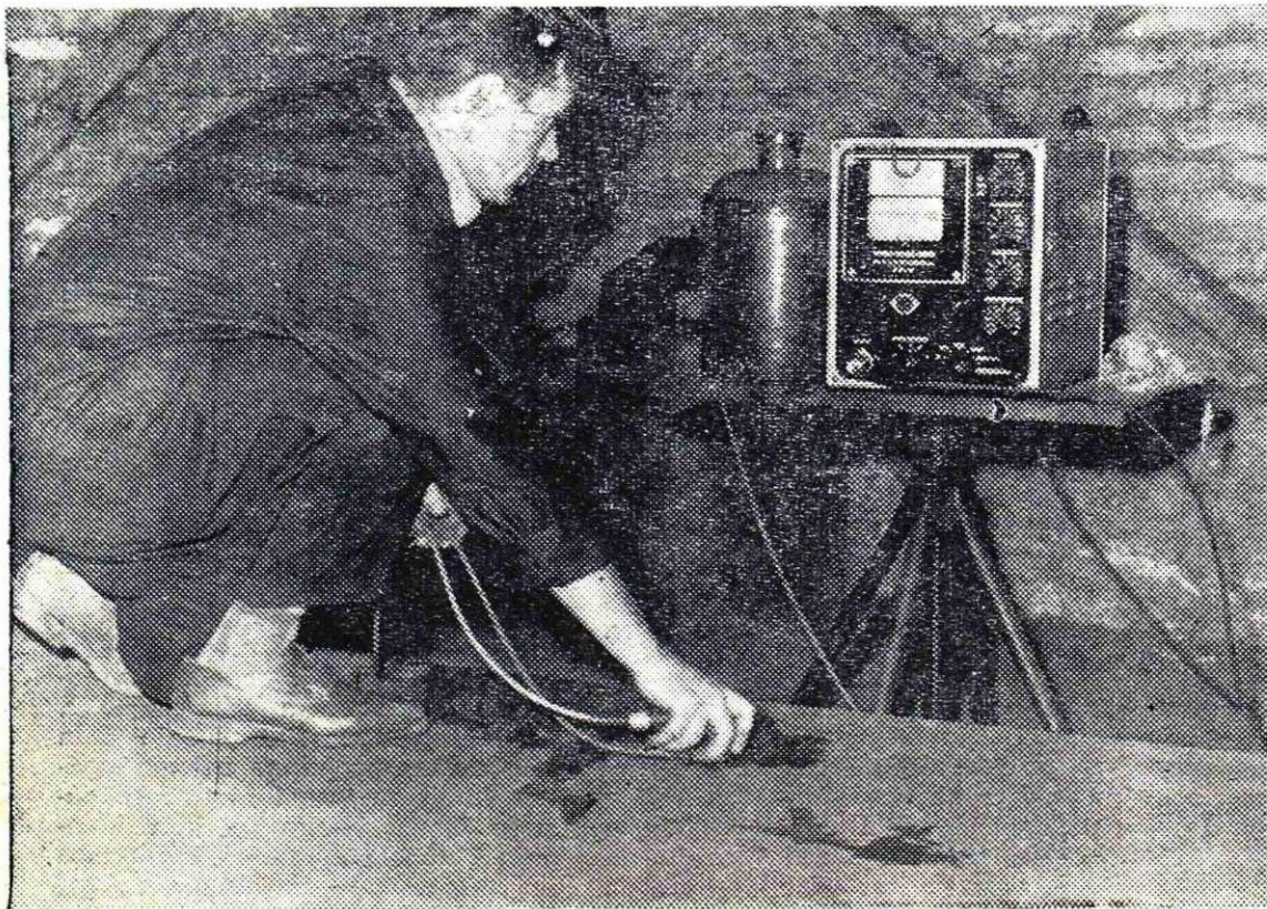
Preiskava debele pločevine z ultrazvokom
