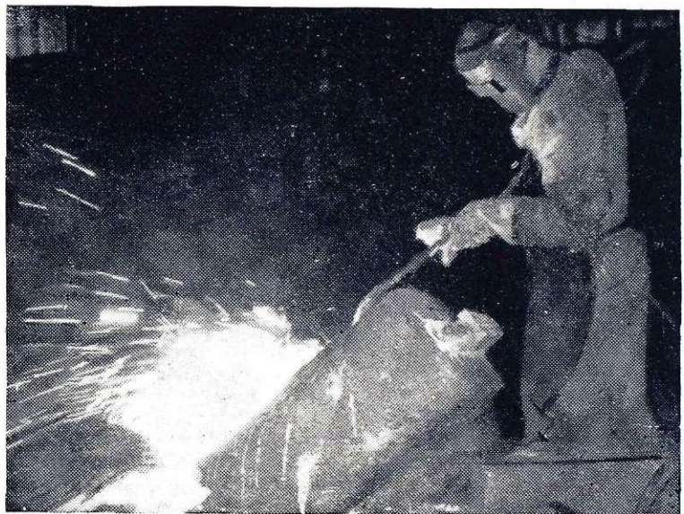
Flemanje bram na Javorniku v valjarni 2400 je že v močnem razmahu. Delo pa je naporno in zahteva spretno roko
